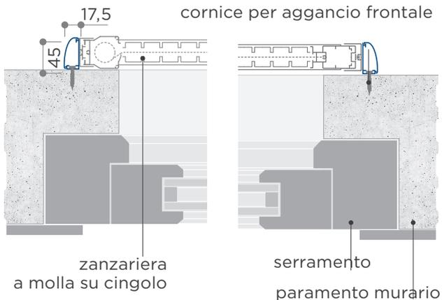
Cornice in estruso d'alluminio composta da **profilo strutturale** di aggancio al paramento murario e carter di chiusura provvisto di sistema di fissaggio a scatto (viti nascoste).
