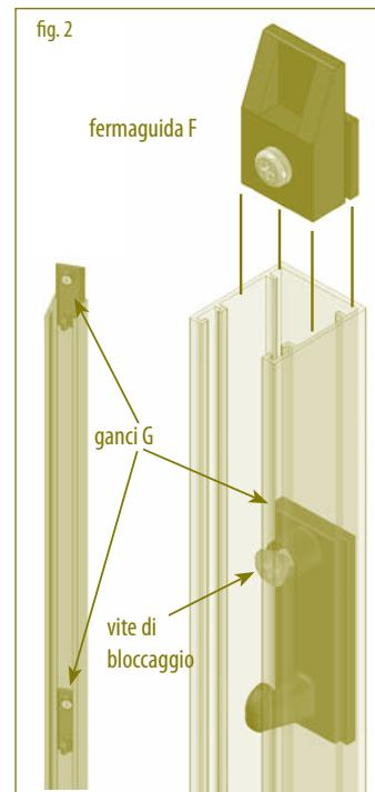
(dettaglio in fig. 3) sorregga la guida stessa. Inserire l'altro estremo nella battuta e, con movimento a compasso, spingere verso l'alto. Sollevare il fermaguida F a bloccare la guida e stringere la vite.
