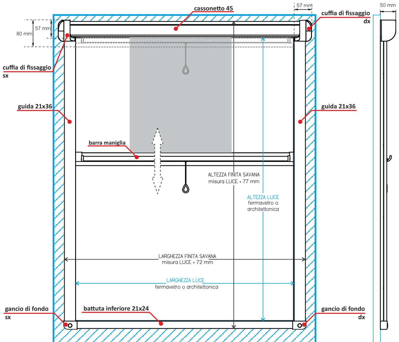
**Fissaggio su serramento:** usare le viti auto-foranti da 16 mm per le cuffie (n. 4) e quelle da 25 mm per i ganci di fondo (n. 2). Per le guide utilizzare le viti da 9 mm.
