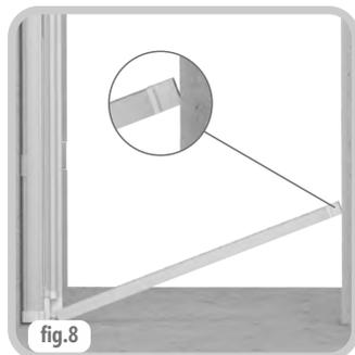
fig.8 inserire la guida inferiore
