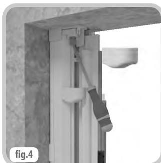
fig.4 rimuovere la cover e serrare la vite della testata superiore. Se si valuta che la tenuta non sia sufficiente, si può fissare la cuffia tramite viti adeguate.
