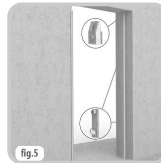
fig.5 fissare la battuta laterale al muro con gli accessori inseriti
