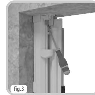
fig.3 rimuovere la cover e serrare la vite della testata superiore. Se si valuta che la tenuta non sia sufficiente, si può fissare la cuffia tramite viti adeguate.
